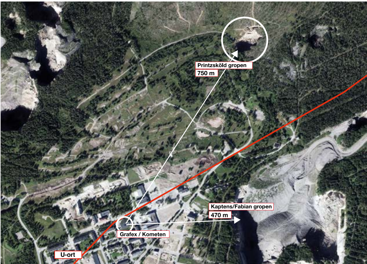
Rasgroparna ligger bara några hundra meter från Kometens fastighet, på kartan kan man även se att en gruvort (röd linje) går rakt under fastigheten.
